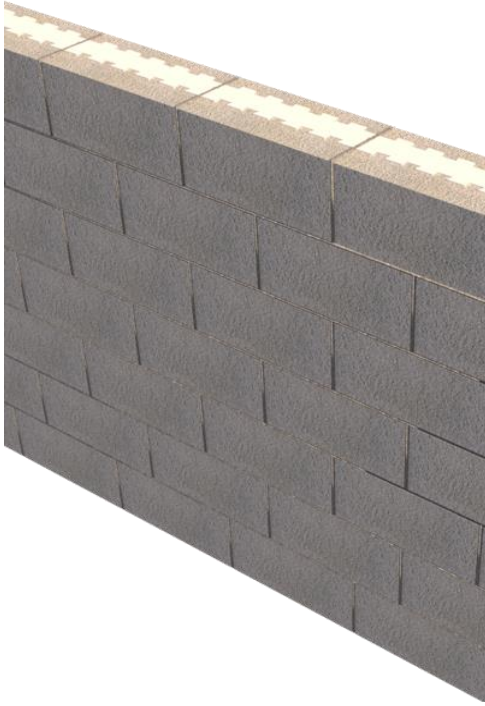
رسم توضيحي 7: جدار من البلوك المحشو بمادة العزل الحراري
